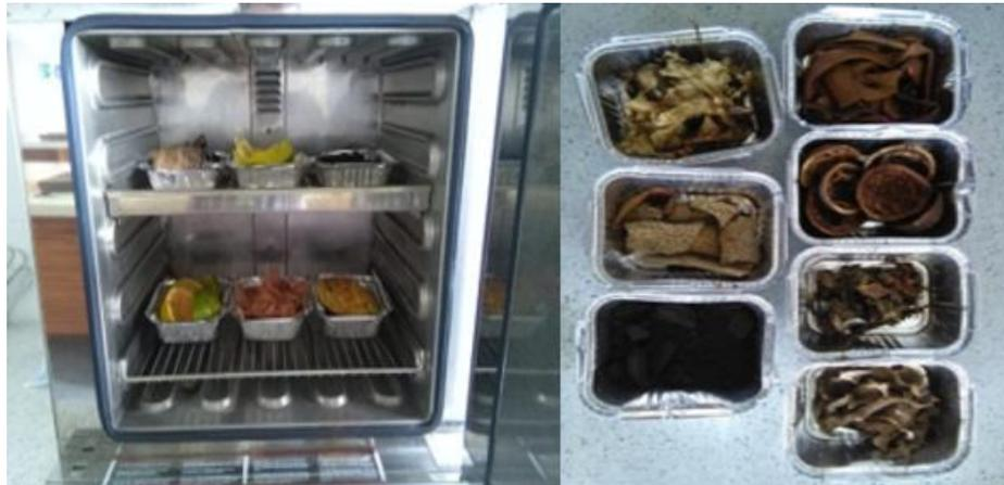
Figura 7. Proceso de secado de residuos (horno) y residuos Orgánicos secos.
