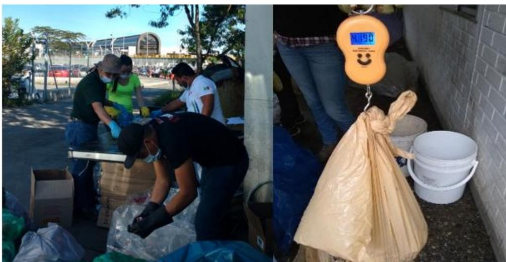
Figura 4. Actividad de separación de residuos por tipo y medición de peso para cada tipo de residuo.
