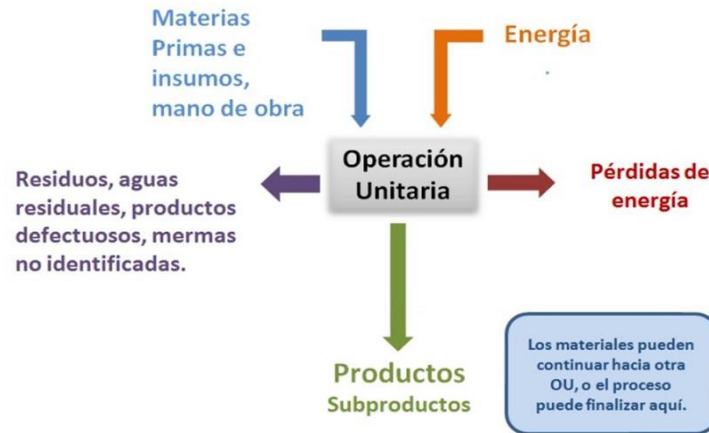
Figura 1. Análisis de entradas y salidas de las operaciones del proceso productivo. Obtenido de
