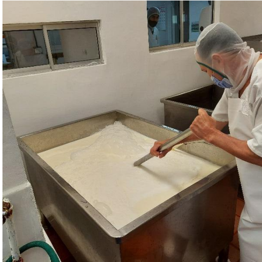
Figura 7. Mezclado de leche con otros ingredientes como calcio, cuajo y bioprotector.
