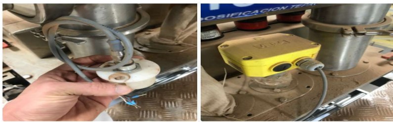
Figura 13 Cambio de sensor réflex por sensor de contacto
