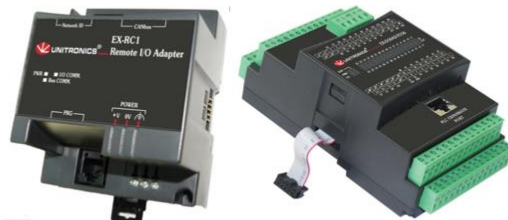
Figura 22. Módulo EX-RC1 y módulo IO-D16A3-RO16. Fuente: (Unitronics, s.f.)
