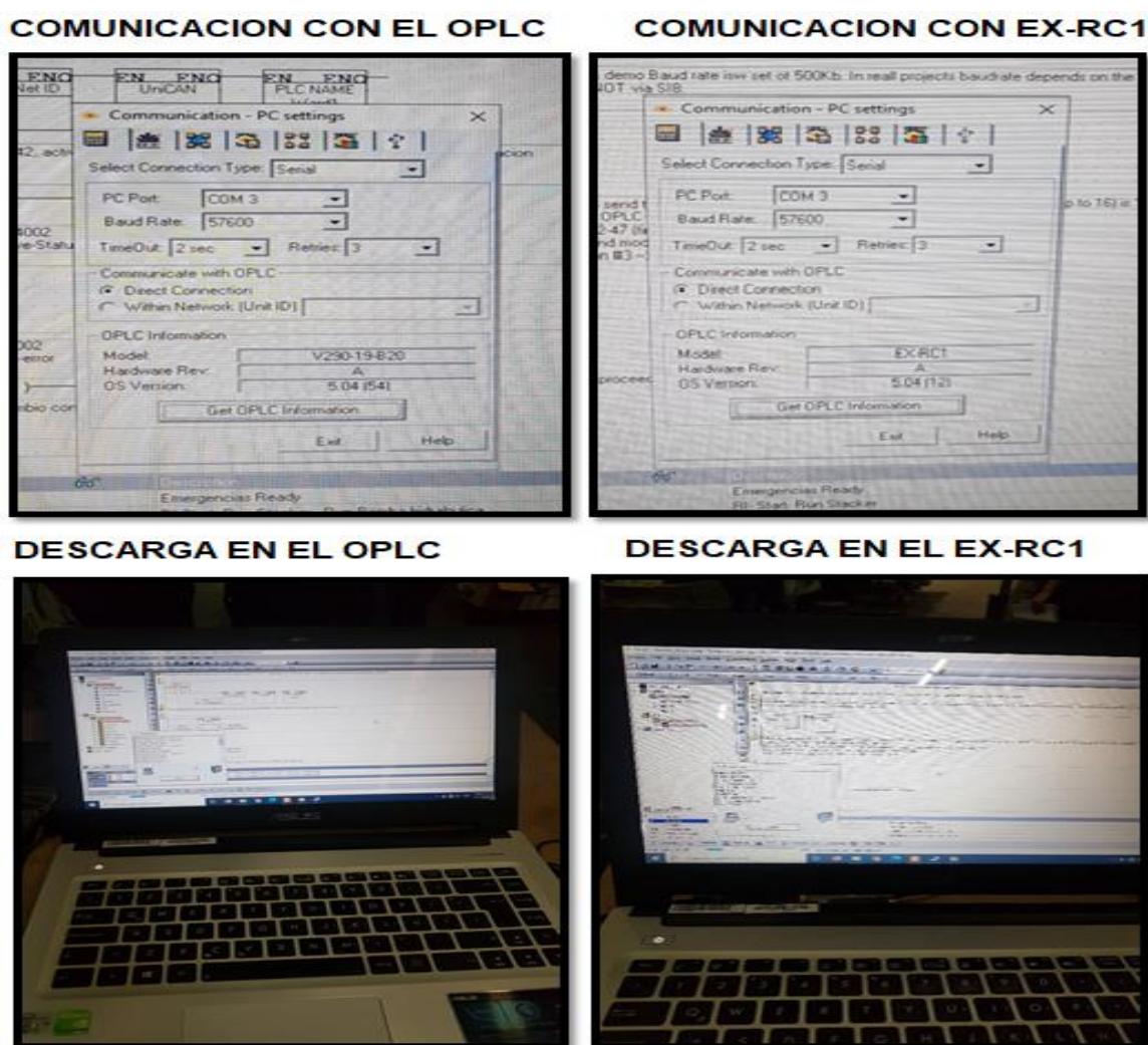
Figura 59. Comunicación y descarga de programas en los dispositivos OPLC V290 y EX-RC1. Fuente: Elaboración propia.
