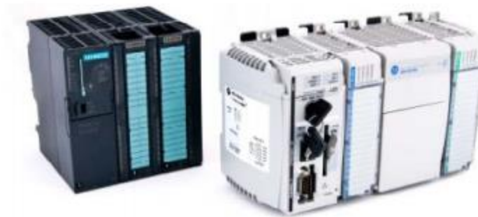
Figura 7. Ejemplos de PLC modulares. Fuente: (DIEEEEC, 2011)
