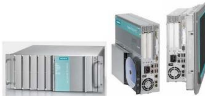
Figura 10. Ejemplos de PC industriales. Fuente: (DIEEEEC, 2011)
