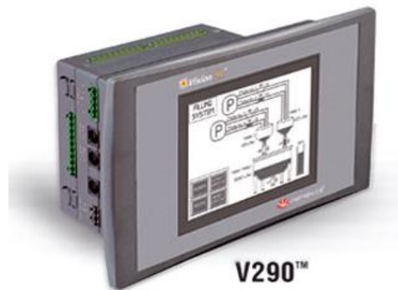
Figura 20. OPLC Unitronics serie Visión (V290-19-B20B). Fuente: (Unitronics, s.f.)
