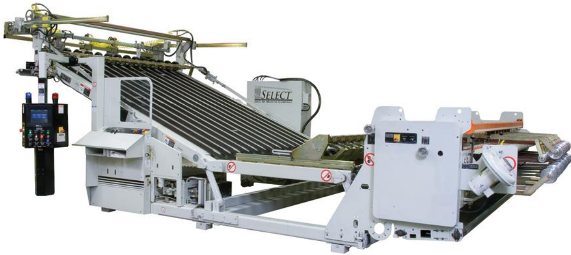
Figura 2. Apilador automático (Stacker). Fuente: (Geo. M. Martin Company, 2017-2019).
