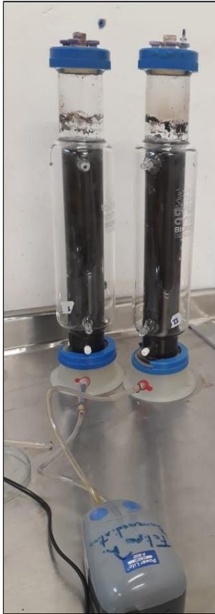
**Figura 5.** Reactores airlift con el agua coloreada y la biomasa listos para iniciar la biodecoloración
