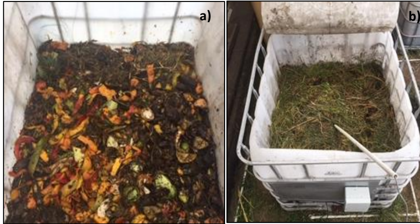
Figura 2. Conformación de los tanques con residuos orgánicos. a) Capas de residuos orgánicos y b) tanque completo hasta el 70% de su capacidad.
