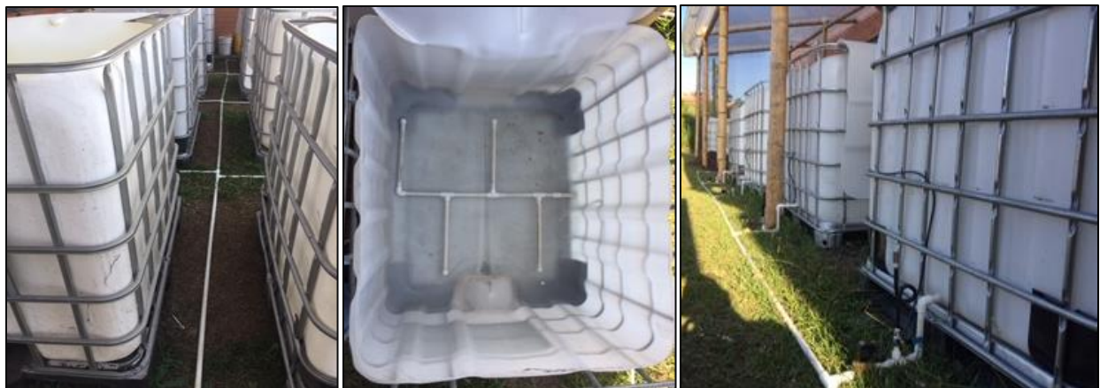
Figura 1. Red tubular de aireación para el sistema de compostaje.
