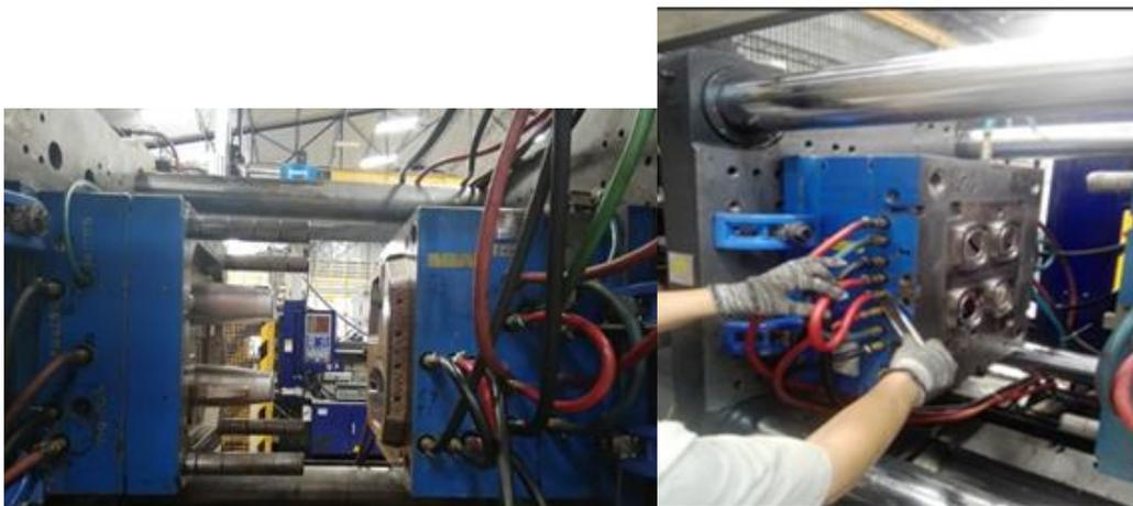
*Figura 9. Colocación de mangueras al molde. Fuente: Imágenes tomadas por el autor.*
