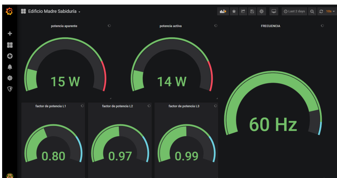
Figura 5. Visualización de potencias, factor de potencia y frecuencia. Fuente: elaboración propia.
