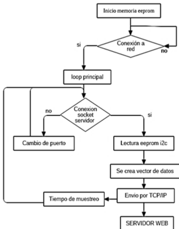
Figura 4. Diagrama de flujo del módulo ESP8266. Fuente: elaboración propia.
