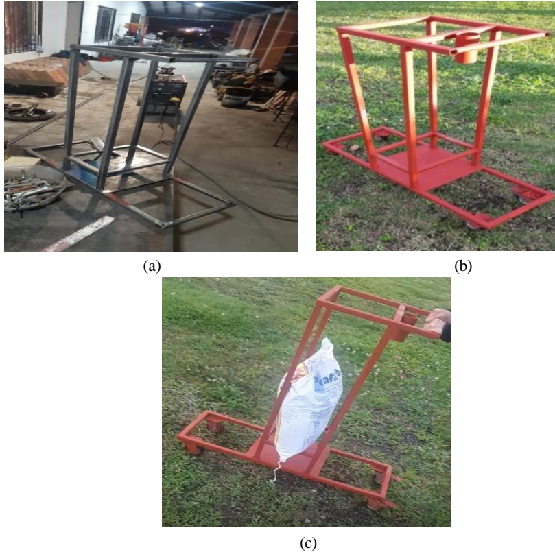
Figura 30. Proceso de construcción del vehículo, elaboración propia (2020). (a). Ensamble inicial; (b). Prototipo del vehículo de transporte de varilla; (c). Prueba de resistencia y estabilidad del carrito
